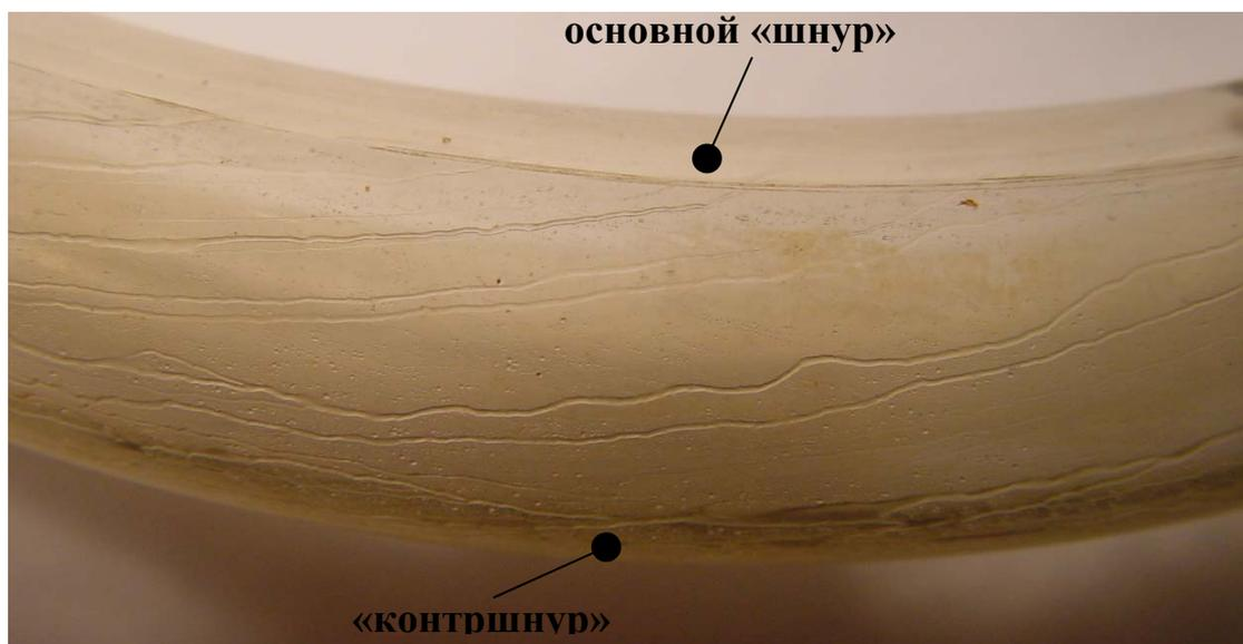
Рис.4. Фотография «двухшнурного» дисперсного режима (вид А на рис.3)
