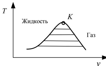
Рис. 1.11. Кривая испарения в координатах  $T, v$  [4]
