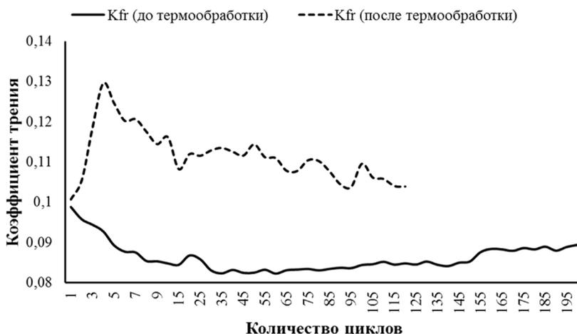
Рис. 2. Зависимость  $K_{тр}$  от количества сканирований для покрытия Ti-(Ti+a-C)
