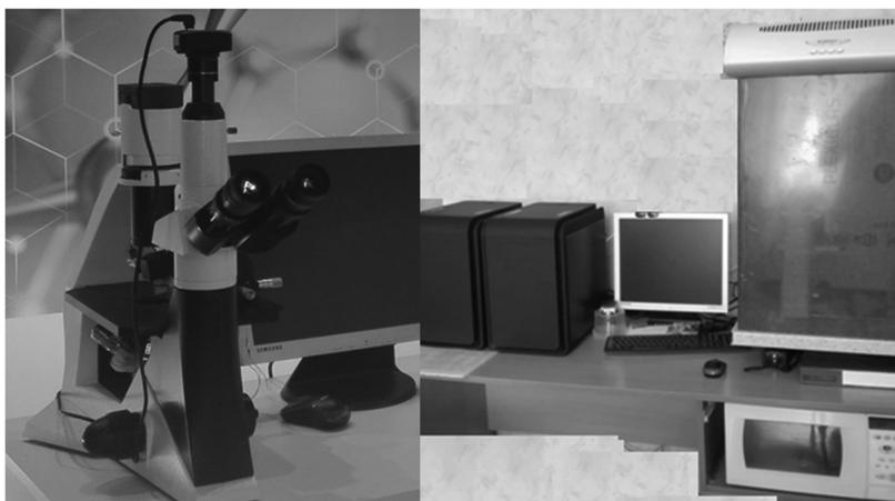
Рис. 3. Аппаратно-программный исследовательский комплекс, установленный в Институте тепло- и массообмена имени А. В. Лыкова НАН Беларуси (слева – совмещенный флуоресцентный микроскоп с АСМ-сканером, справа – комплекс с системой жизнеобеспечения биологических структур)
