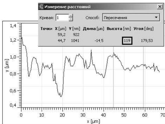
Рис. 7. Измерение толщины пленки ВС на поверхности ролика после испытаний: профиль секущей на границе фаз
