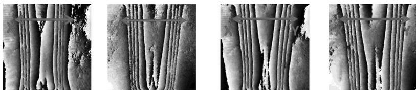
Рис. 5.30. Тальботограммы пламени, полученные в Делийском технологическом институте, г. Нью-Дели, Индия [37]
