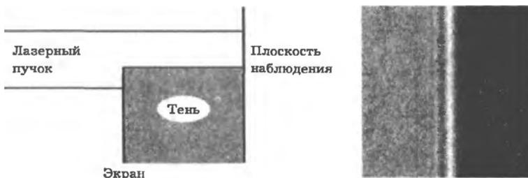
Рис. 3.2. Дифракция при освещении непрозрачного экрана лазерным излучением
