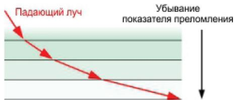
Рис. 2.36. Отклонение светового луча в сторону большей плотности
