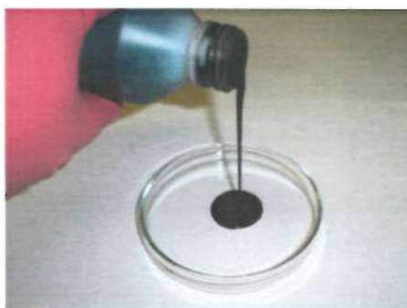
Рис. 2. Чернила для 2D-принтера на основе композита ВОГ-ГК
