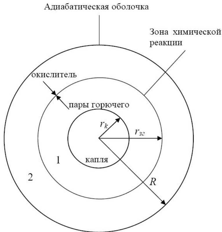
Рис.1. Модель горения капли жидкого горючего в адиабатической оболочке.
