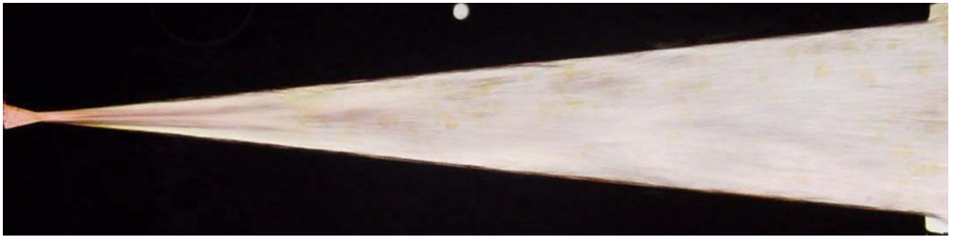
Рис. 4. Структура потока при истечении воды в разреженную среду с противодавлением менее давления насыщения ( p_1 < p_s(t_0) ). Угол раствора сопла 12^\circ . а – t_0 = 70^\circ\text{C} , p_0 = 80 кПа, p_1 = 27 кПа; б – t_0 = 70^\circ\text{C} , p_0 = 80 кПа, p_1 = 8 кПа
